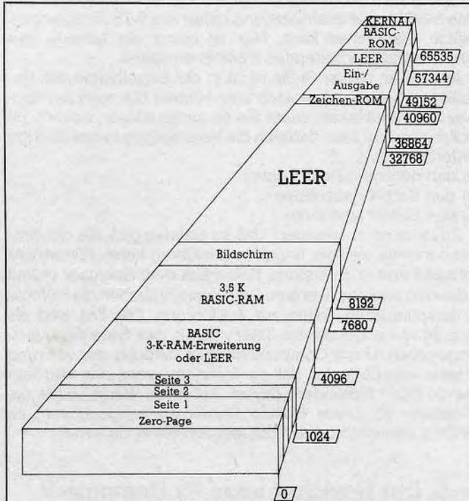
Bild 3. VC 20-Speicher (Grundversion oder mit 3-KByte-Erweiterung)
